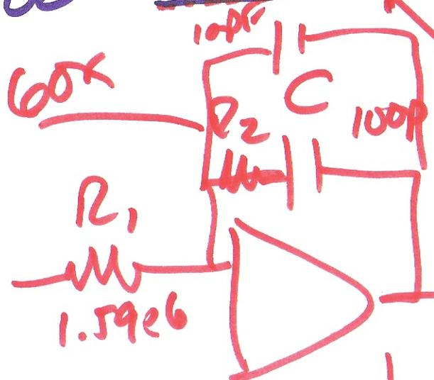
$$\frac{\frac{1}{j\omega C} + R_2}{R_1} \cdot \frac{1}{1 + j\omega R_2 C}$$
