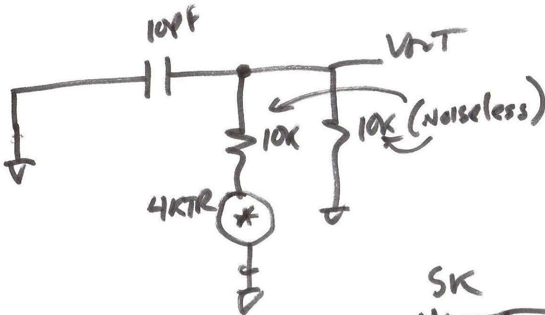
$$4\text{kTR} \cdot \left( \frac{10\text{k}}{10\text{k} + 10\text{k}} \right)^2$$
